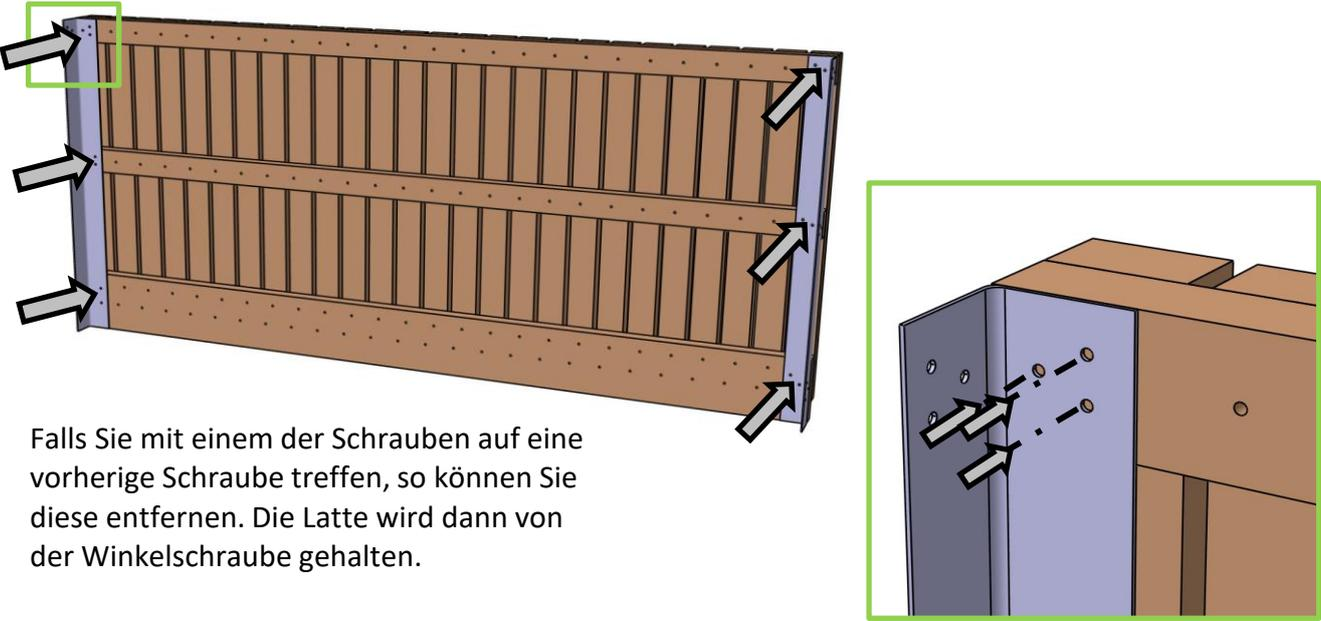
Falls Sie mit einem der Schrauben auf eine vorherige Schraube treffen, so können Sie diese entfernen. Die Latte wird dann von der Winkelschraube gehalten.
