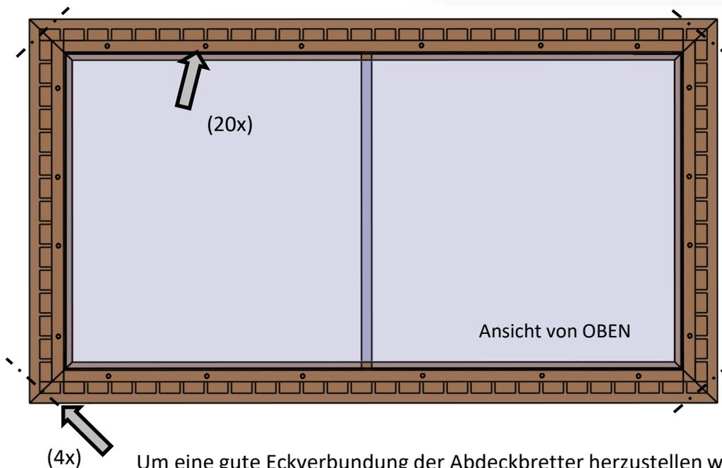
Um eine gute Eckverbundung der Abdeckbretter herzustellen werden an den Ecken auch waagerechte Schrauben diagonal eingedreht.
