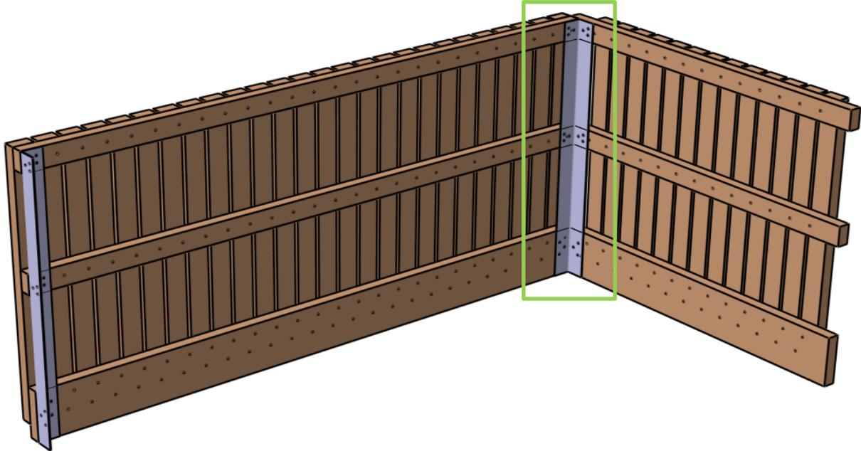
**ACHTUNG:** Nur die beiden markierten Löcher verwenden und die **Schrauben** etwas **schräg eindrehen**, sodass diese die Latte treffen und nicht ins Freie ragen!
