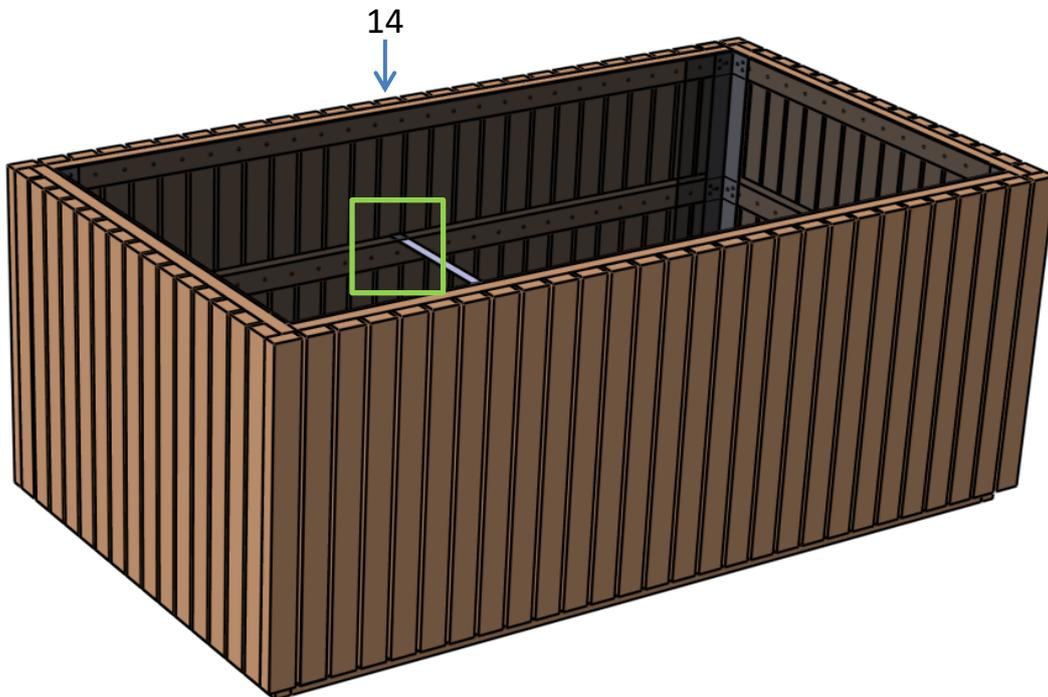
Die Verstrebung nicht genau auf die Bohrung richten sondern etwas versetzen, um später mit der Schraube nicht zu kollidieren.
