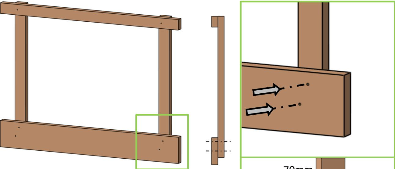
Ist der Rahmen ausgerichtet, so wird eine weitere Schraube pro Seite eingedreht.
