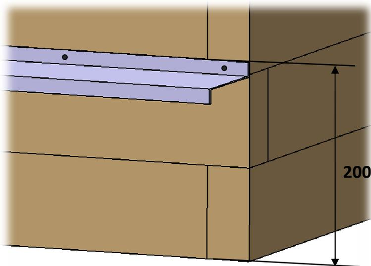
Die Schneckenschutzleisten werden, gemessen von der Unterkante des Hochbeetes, etwa in einer Höhe von 200 mm befestigt. Dazu werden selbstschneidende Schrauben verwendet die ohne Vorbohren durch die Leisten ins Holz geschraubt werden können.
